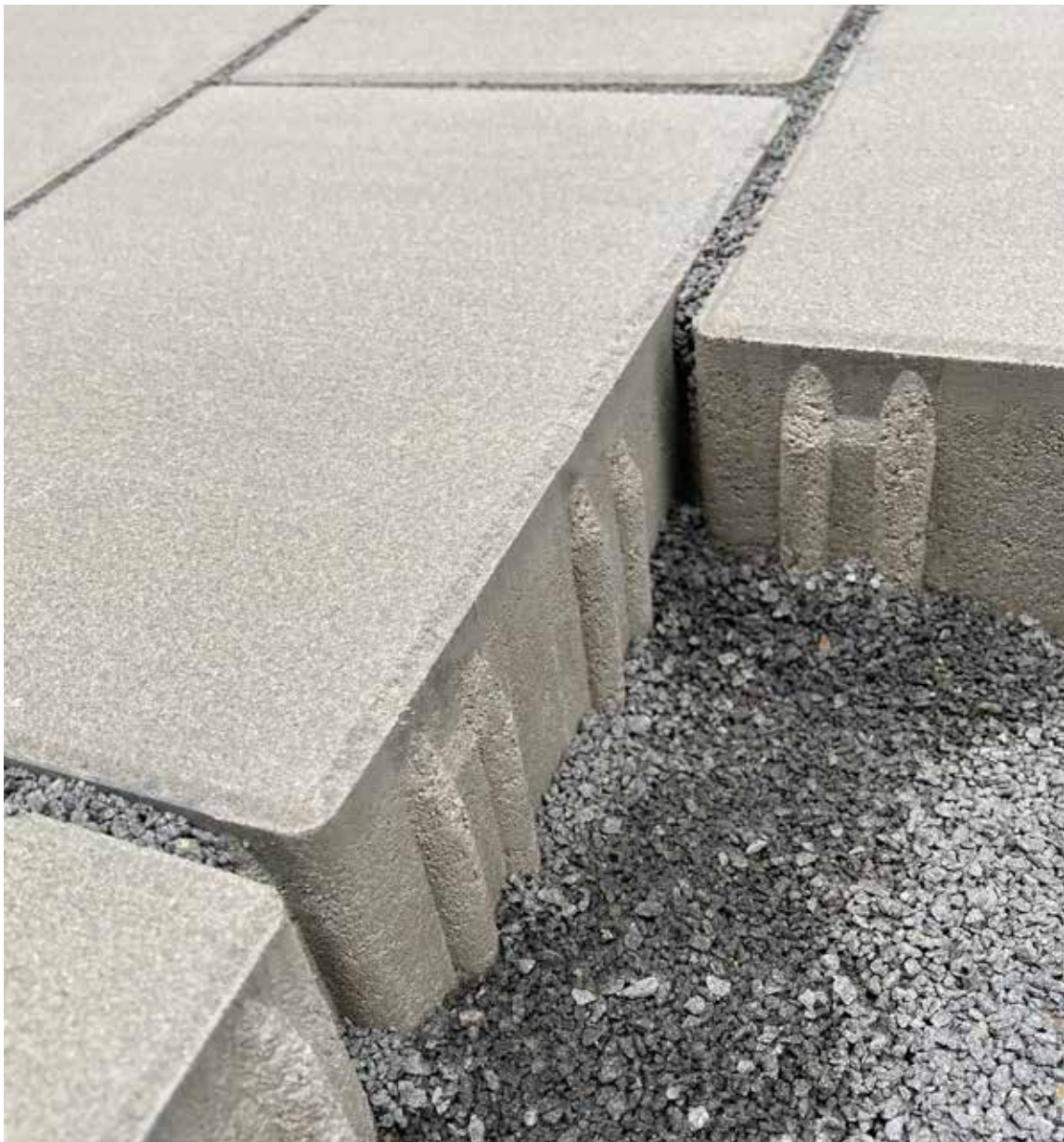
28/21/8 cm mit 8 mm Abstandhaltern zur Versickerung von Niederschlagswasser über die Fuge grau
